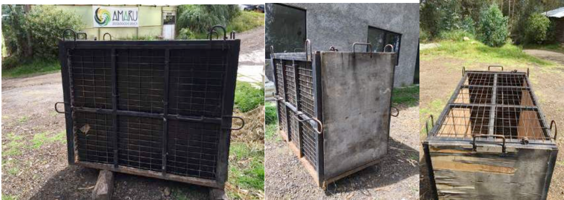
Fotografías arriba de izquierda a derecha de la vistas lateral, frontal y superior de un jaula o contenedor de hierro rígido construido para la movilización de osos andinos, nótese las puertas tipo guillotina, la estructura reforzada, las paredes laterales cubiertas con planchas de madera. © Victoria Arbeláez
